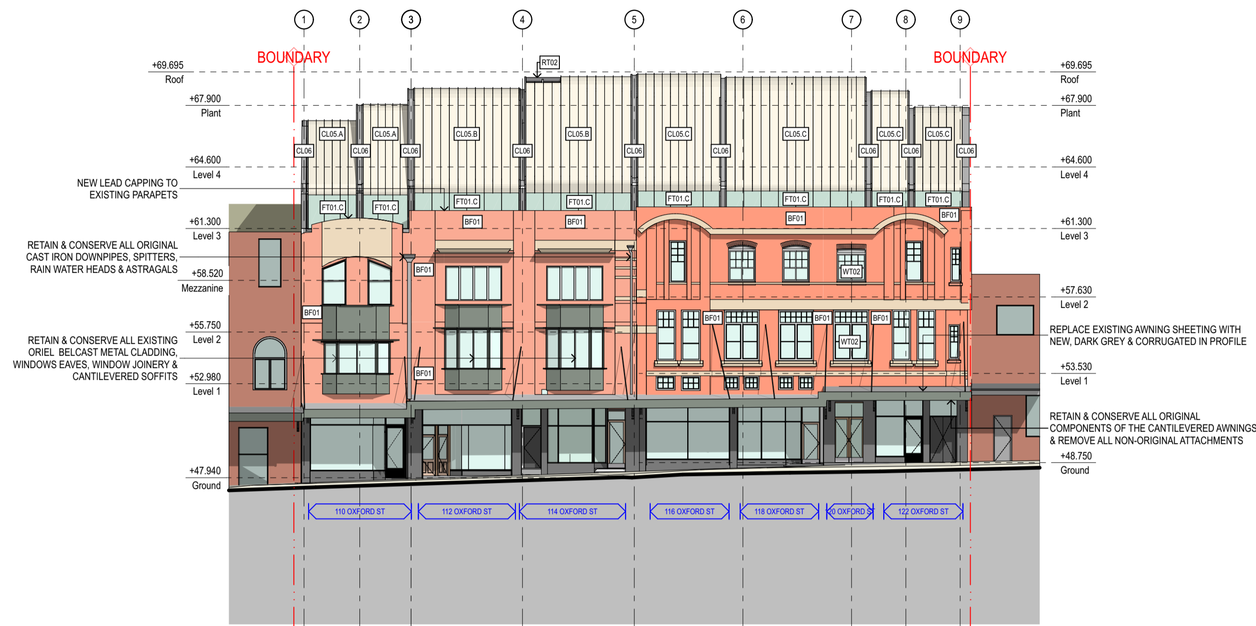
1 ELEVATION Oxford St Elevation 1:200
